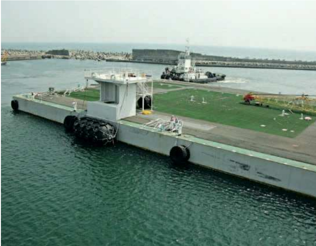
F) Das »Megafloat«, das zur Lagerung von kontaminiertem Wasser genutzt wurde, wird in den Hafen der Anlage geschleppt (Quelle: TEPCO)
